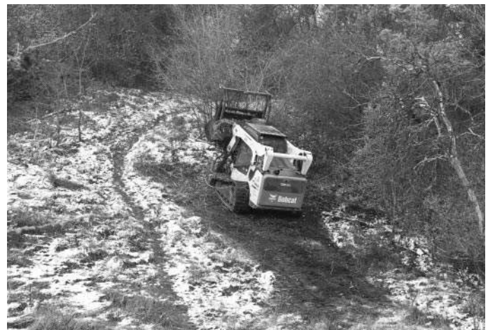
Auch an Hängen mit stärkerem Gefälle kann dieser Forstmulcher eingesetzt werden.
