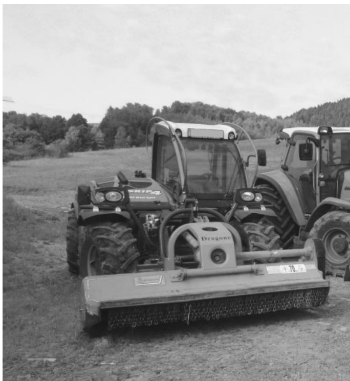
In steileren Bereichen können Hangtraktoren mit Mäh- und Mulchwerkzeug eingesetzt werden (M. Urbach)
